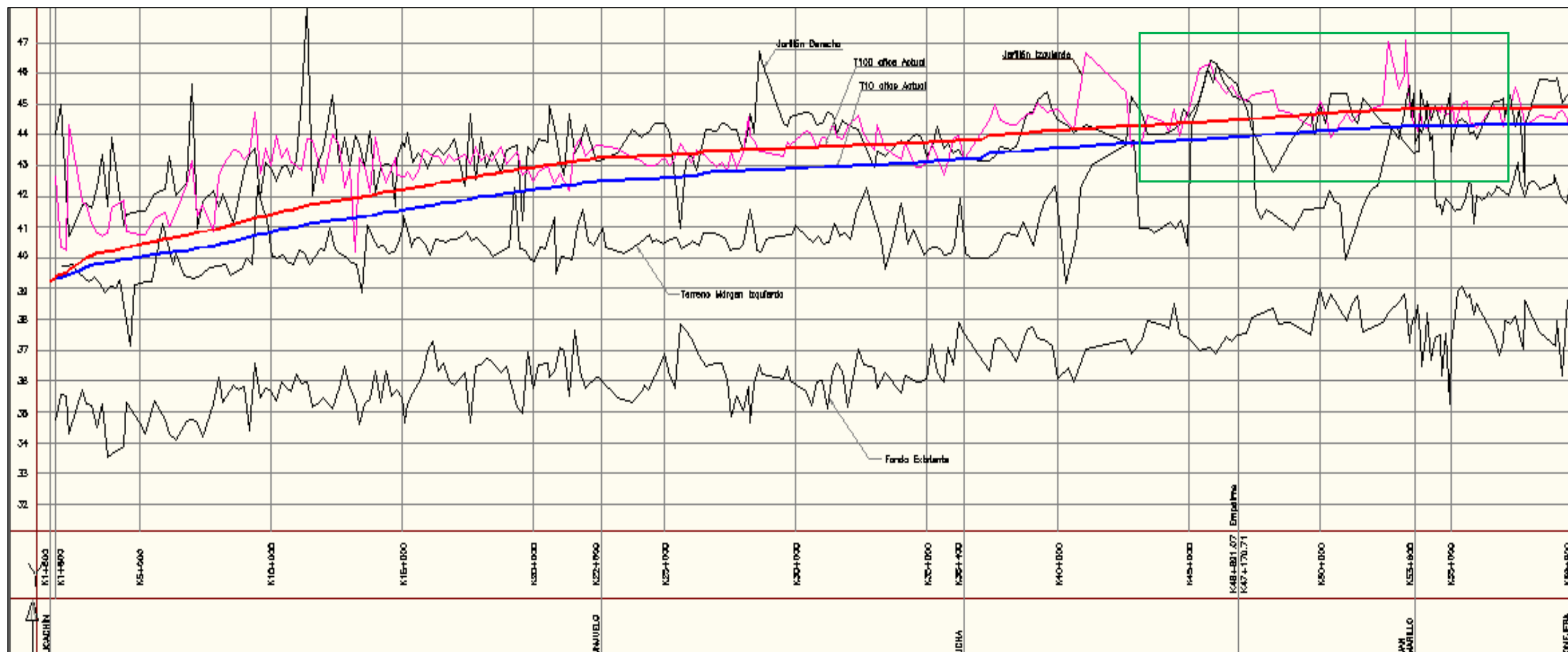
Figura 45 Niveles de energía para caudales con período de retorno de 10 y 100 años frente a altura de jarillones actuales
